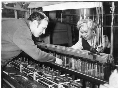
*Изготовление электронагревательной тканой ленты*
